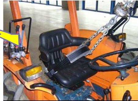
**Ad esempio tutte le trattrici agricole indistintamente gommate o cingolate dovranno essere dotate di ROPS e di cinture di sicurezza che dovranno essere utilizzate.**
